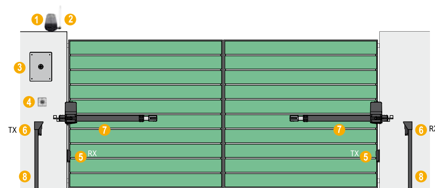
1_Pirilampo 2_Antena 3_Central eletrônica 4_Seletor de chave 5_Fotocélula exterior 6_Fotocélula interior 7_Motores 8_Suporte em ferro para fotocélulas
