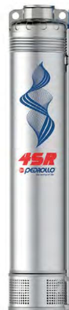
**Características:** Turbinas oscilantes ajustáveis ao movimento axial evitam o seu bloqueio (Patente Registada) • Permitem a passagem de areias até 150 g por m<sup>3</sup> • Componentes em aço inox de alta qualidade • Difusores e turbinas em noryl • Tampa do difusor em aço inox • Não necessitam de qualquer tipo de manutenção • Temperatura máxima do fluido 35 °C.
