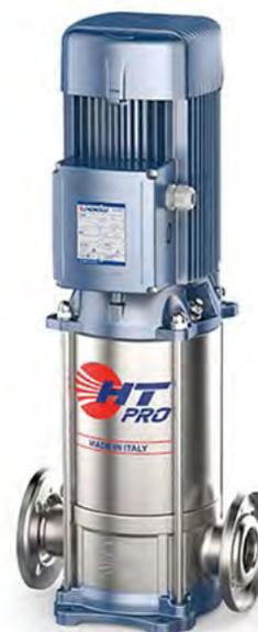
**Características:** Totalmente em aço inox: corpo bomba, tampa do retentor, turbinas e difusores em aço inox AISI304 • Veio em aço inox AISI316 • Aspiração máxima 7m • Temperatura máxima do fluido -15 °C a + 90 °C • Isolamento classe F • Classe de eficiência IE3.
