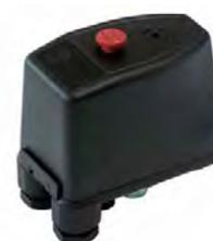
**Características:** Contactos normalmente fechados • Botão on/off exterior • Válvula de descarga de ar incorporada • Diferencial min./máx. 1,5 a 5 bar • IP44 • Temperatura máx. 55 °C • Corrente máx. 16 (10) A.
