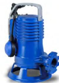
**Características:** Turbina aberta multicanal • Triturador incorporado na aspiração que permite fracionar partículas sólidas • Veio em aço inox • Temperatura máxima do fluido 40 °C • Todos os modelos em 240 V incluem interruptor de boia • Equipadas com 2 retentores especiais em carboneto de silício em câmara de óleo • Número máximo de arranques por hora: 30.
