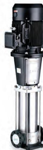
**Características:** Todos os componentes em contacto com a água são em aço inox Aisi 304 • Elevada resistência à corrosão • Temperatura máxima do fluido 120 °C • Temperatura máxima ambiente 40 °C • Isolamento Classe F • IP55.
