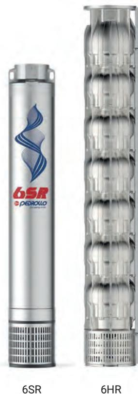
**Características:** Camisa da bomba em aço inox Aisi 304 • Turbinas e difusores em noryl • Grelha de aspiração e régua de proteção do cabo de alimentação em aço inox Aisi 304 • Permitem a passagem de areias até 100 g por m<sup>3</sup> • Limite de imersão 200 m • Temperatura máxima do fluido 35 °C.
