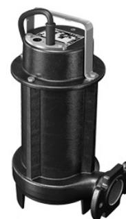
**Características:** Turbina aberta multicanal • Triturador incorporado na aspiração que permite fracionar partículas sólidas • Veio em Aço Inox • Número máximo de arranques por hora: 30 • Temperatura máxima do fluido: 40 °C • Todos os modelos em 240 V incluem interruptor de boia.
