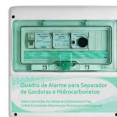
**Constituído por:** Caixa plástica 335x340x160 • Relé de nível para controlo de nível de água • Modulo alarme sonoro e luminoso • Proteção contra curto-circuitos • Sinalizador luminoso para aviso de excesso de gorduras acumuladas e falta de água no deposito separador de gorduras.
