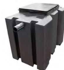
**Características:** Construído com base na norma EN858-1: 2002 e segundo os requisitos da directiva 89/106/CEE • Decantador incorporado • Filtro coalescente lamelar e oleofílico • Obturação automática com válvula em PEAD.
