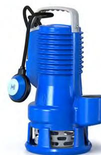
**Características:** Turbina aberta multicanal • Temperatura máxima do fluido 40 °C • Todos os modelos em 240 V incluem interruptor de boia • Equipadas com 5 m de cabo nos modelos 240 V e 10 m nos modelos 400 V • Os modelos DR blue Pro são equipadas com 2 retentores especiais em carboneto de silício em câmara de óleo • Número máximo de arranques por hora: 30.
