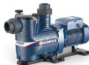
**Características:** Eletrobomba centrífuga • Ferragem automática • Corpo de bomba e suporte de corpo de bomba em polipropileno reforçado com fibra de vidro • Veio do motor em aço inox AISI431 • Turbina Noryl • Retentor cerâmico e sede em grafite • Aspiração máxima 4 m • Temperatura máxima fluido 45 °C • Temperatura máxima ambiente 50 °C • IPX4 • Pressão máxima de trabalho 2.5 bar.
