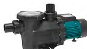
**Características:** Eletrobomba centrífuga • Ferragem automática • Turbina em noryl • Veio em aço inox • Pré-filtro incorporado • Motor elétrico com térmico de proteção incorporado em 240 V • Temperatura máxima do fluido 35 °C • IPX5.
