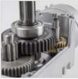
A mecânica robusta com engrenagens em aço maquinado garante fiabilidade e durabilidade ao longo do tempo
