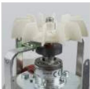
Ventilação forçada adicional (versões de 230V), com codificador magnético
