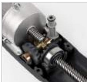
A mecânica robusta com engrenagens em aço maquinado garante fiabilidade e durabilidade ao longo do tempo
